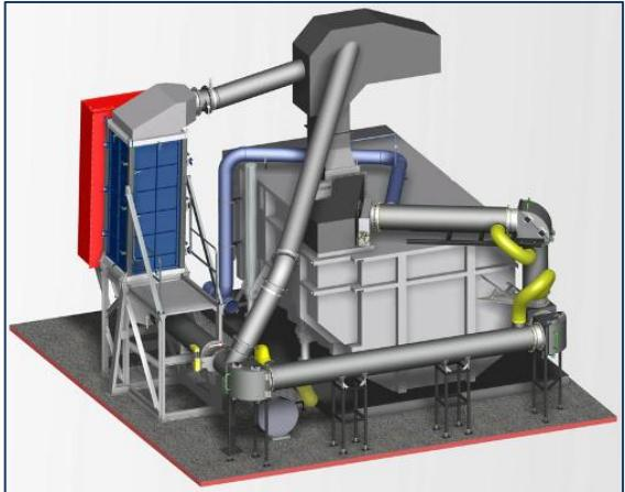
Systém pre spätné získavanie tepelnej energie z odpadového tepla prostredníctvom výmenníkov tepla (voda, vzduch)
