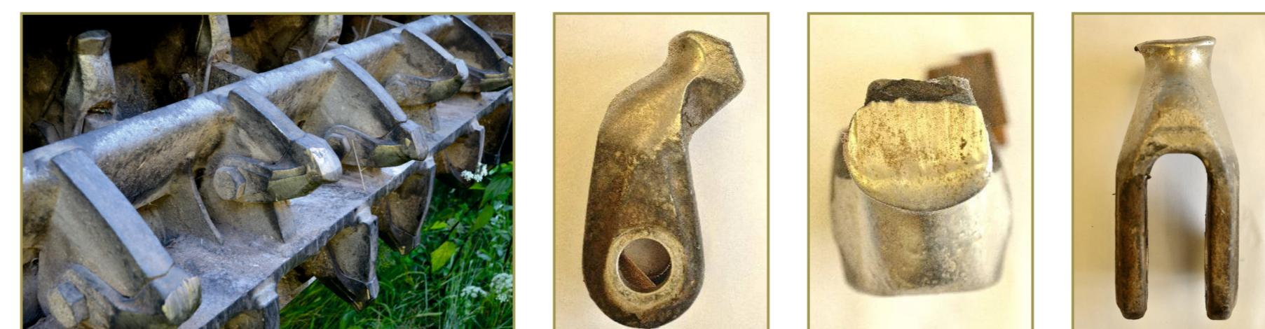
Obr. 2 Úbytok materiálu na nástroji
